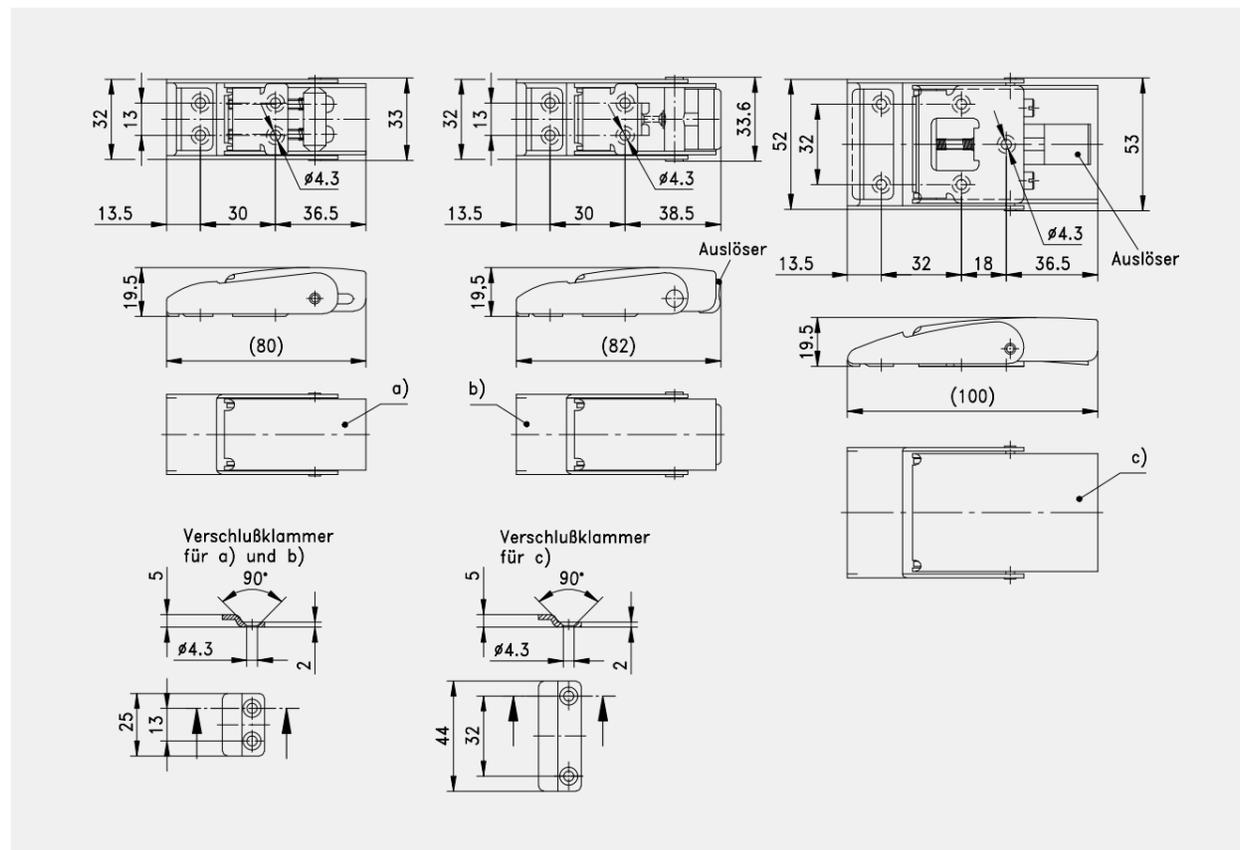
Spannverschluss mit Verschlussklammer
