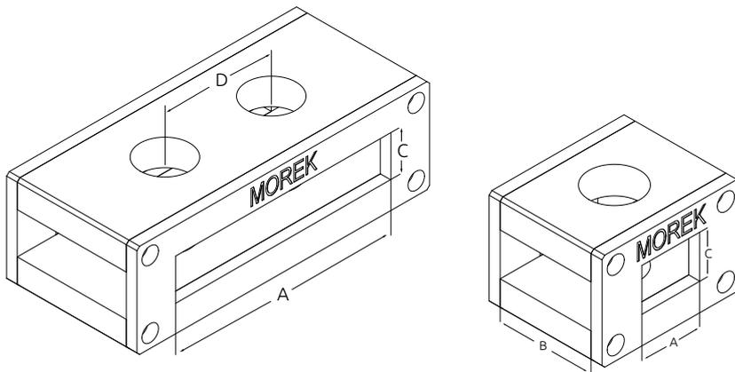
**Bohrführung für Bohrwerkzeug**
