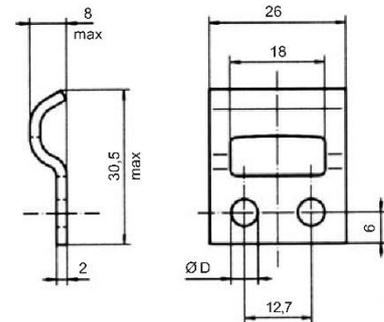
Bohrbild für Spannverschluss offene Basis/Gegenhaken mit Führung
