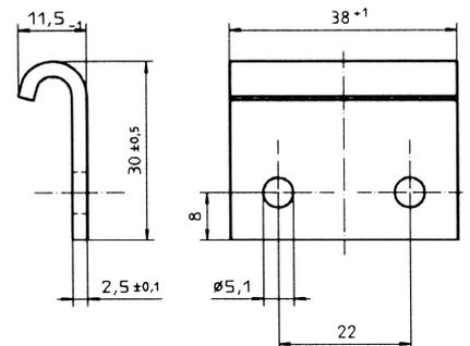
Bohrbild für Spannverschluss/Gegenhaken kurz
